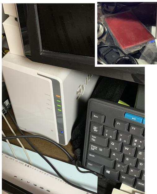
左の写真は会報誌専用ハードディスク（赤い物体）をミラーリングでバックアップしているNAS（ネットワーク接続型ストレージ・白い物体）です。一番上のLEDがオレンジ色になってピーッピーッと鳴っています。2台内蔵している3テラバイトのハードディスクのうち1台が「信頼性が低下しています。初期化しました。」という警報でした。と言う事でDisk 1を取り換える事になりました。で、取り外したDiskは完璧には壊れてないようですので捨てるのももったいないのでどうしましょうかと・・・動画が結構な量、保存できそうですが信頼性がね。チェックしたらバッドセクターが出来ただけでした。修復して使いましょ。
